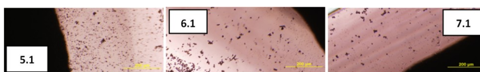
Obr. 17: Uvolňování částic materiálu do média. Mikroskop Olympus IX 51 (obj. 10 \times ), měřítko: 200 \mu\text{m} .
