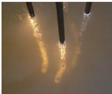
Obr. 12: Výboj plazmatu na rozhraní kov-elektrolyt, kterého je nutno dosáhnout pro vytvoření potřebné keramické vrstvy. Ilustrační foto. VÚHŽ, a.s.
