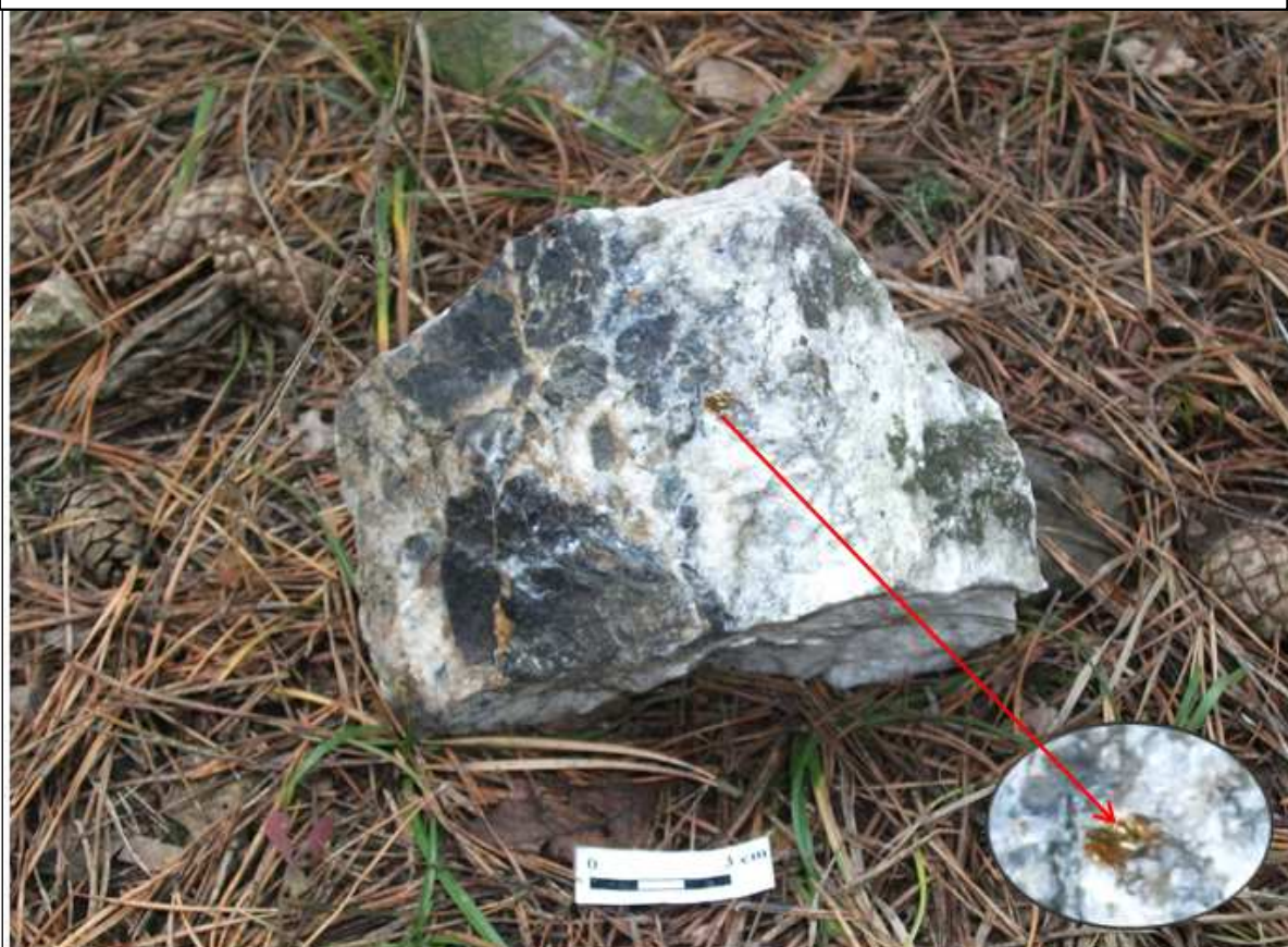
Obr. 4. Vzorek rudniny z centrální části lokality z povrchu zkoumané haldoviny. Křemen s vtroušeným chalkopyritem. V kruhu detail chalkopyritové rudy. Foto autorka
