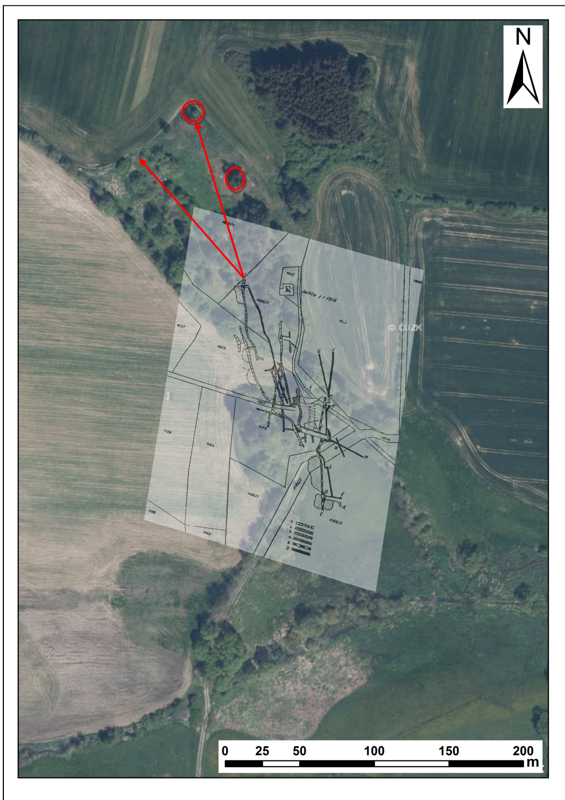
Mapa 5. Důlní plán mutěnských dolů podle F. Kratochvíla ( Kratochvíl 1957 ) na základě podkladů od J. Grimma ( Grimm 1874 ) georeferencovaný přes současný letecký snímek. Červené šipky ukazují pravděpodobný průběh zrudnění na základě průběhu znázorněných štol. Kruhy znázorňují dosud viditelné výskyty malachitu. Zdroj mapového podkladu: https://mapy.cz/letecka
