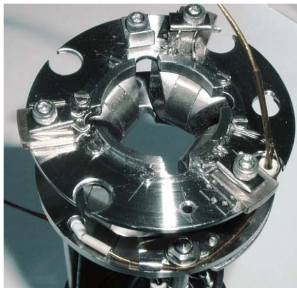
Obrázek 3.5 (vpravo dole): Magnetické tlumení, pohled shora, před provedenými úpravami
