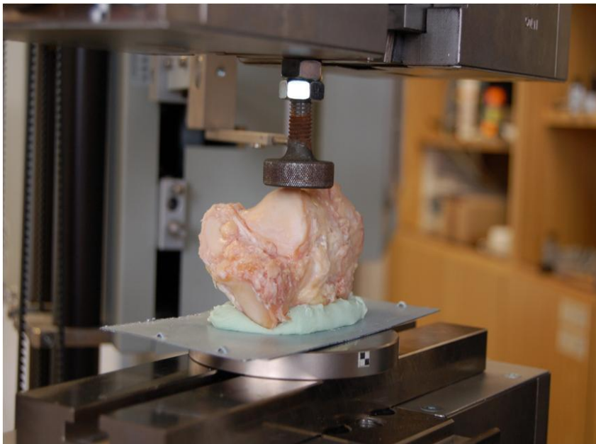
Obrázek – 28 Intaktní patní kost před tlakovou zkouškou
