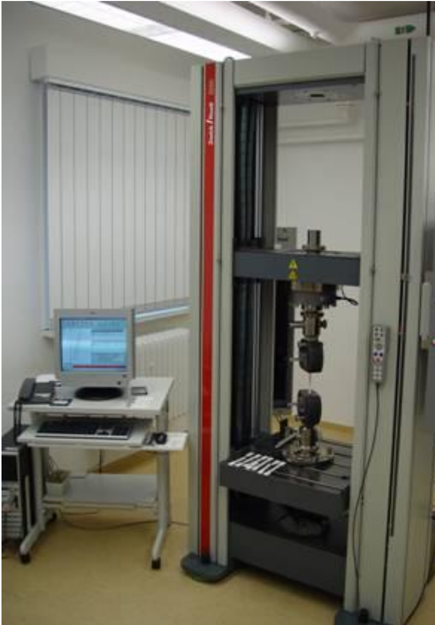
Obr.2 Testovací stroj ZWICK ROELL Z50
