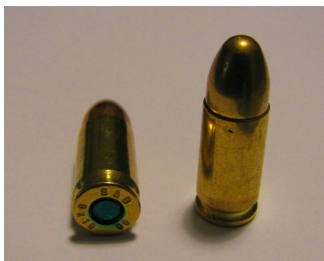
Obr. 3 Náboj Sellier&Bellot 9x19 mm v typové verzi Police – zápalka zelené barvy, zdroj: autor
