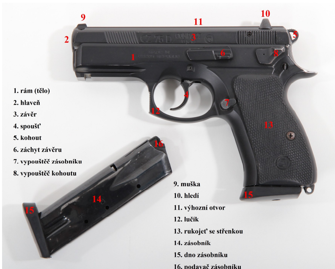
Obr 2. Pistole CZ 75 D Compact a její části, zdroj: autor
