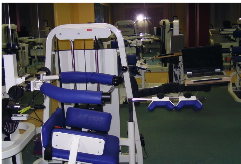
Obrázek 3.2 - 25 - Snímek zařízení firmy Tergumed –testování lateroflexe trupu
