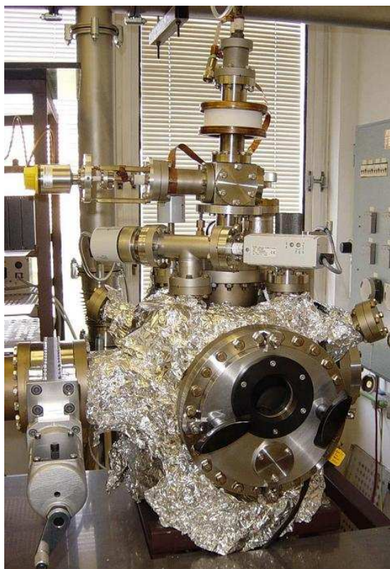
Obr. 1: UHV aparatura pro nanášení tenkých vrstev ve Fyzikálním ústavu AV ČR (obrázek převzat z www stránek http://www.fzu.cz )
