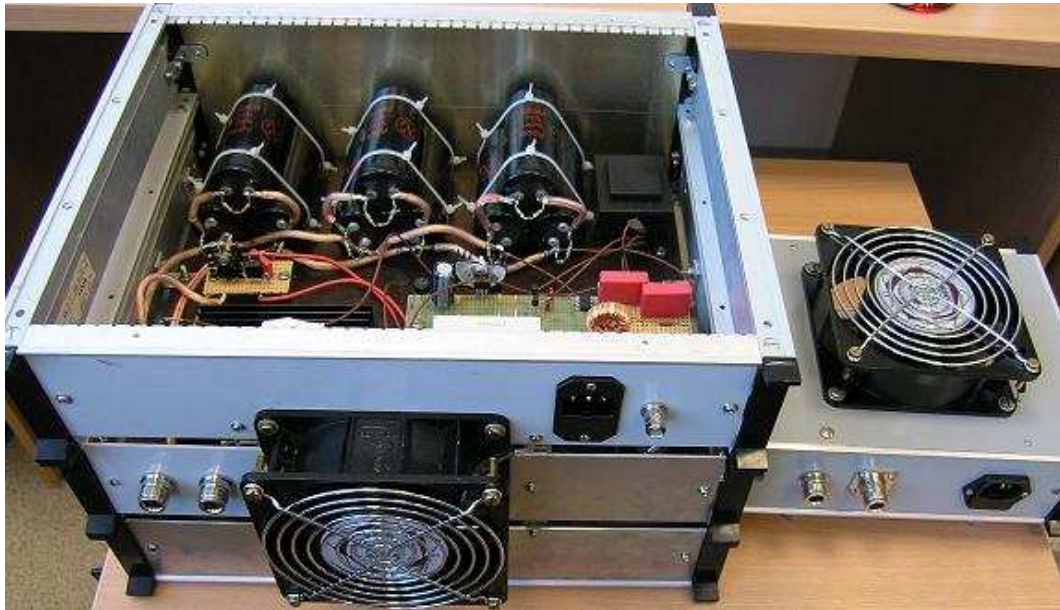
Obr. 24: Celkový pohled na sestavený spínací obvod (vlevo) a zatěžovací jednotku (vpravo). Zátěž představují čtyři paralelně zapojené drátové rezistory.
