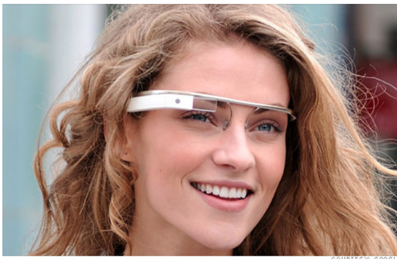
8. Google, Project Glasses (2012). Google Glasses obsahují paměťový procesor, dotykový ovladač, mikrofon, kameru, reproduktory a senzory pohybu.
