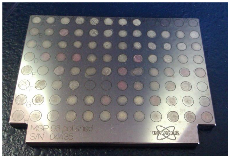
Obrázek č. 5 MALDI destička na nanášení vzorků (M. Nováková, Ústav lékařské mikrobiologie v Motole)
