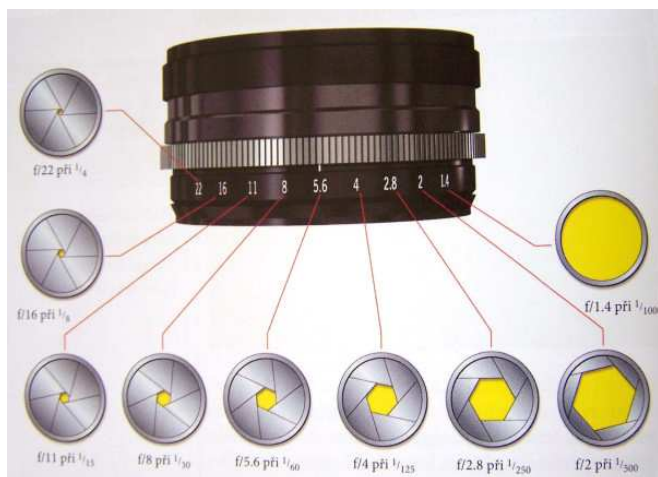
Obr. 2. Otevření clony při jednotlivých clonových číslech
