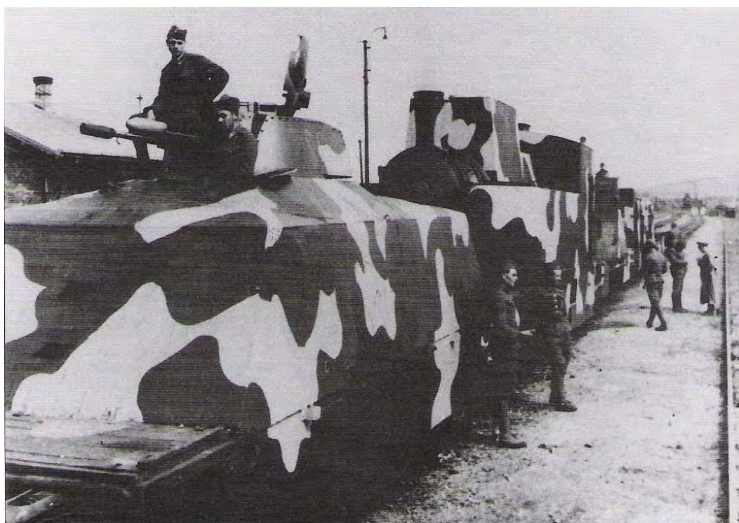
nahoře: Povstalecký obrněný vlak »Masaryk« s tankovým vozem se zabudovaným nepojížděným tankem LT-35.
