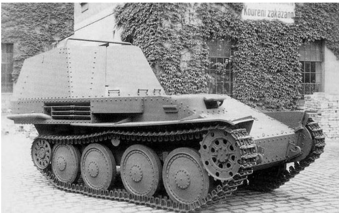
Muniční vůz na základě Marder III Ausf. M (Zdroj: www.panzernet.net )
