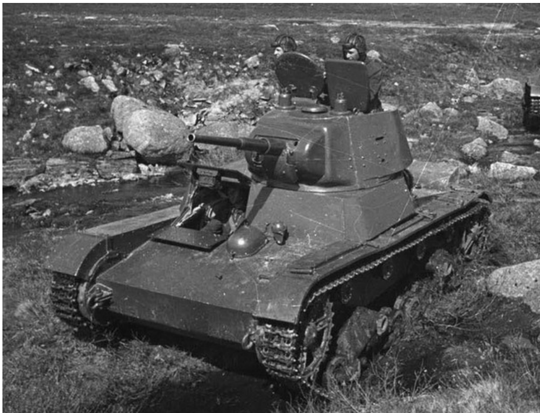
T-26 vzor 1939, zkosené stěny kabiny, kónická věž a zaoblená maska kanónu
