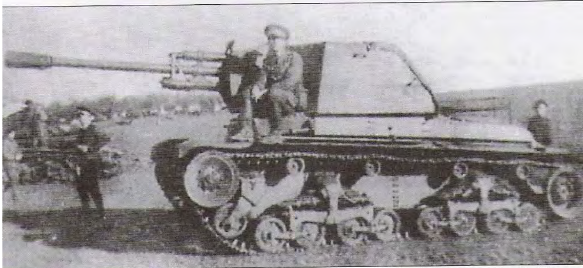
Nahoře: Samohybné dělo TACAM R-2 s instalovaným sovětským 76,2mm kanonem.
