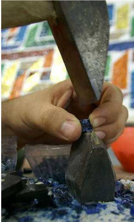
53. Štípání materiálu kladívkem na utínce obrysů 54.
