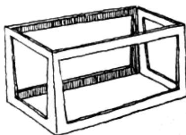
Obr. 7 Schéma akvária s kostrou z umělé hmoty s šikmými vnitřními hranami (Wollner, 1963, s. 39)
