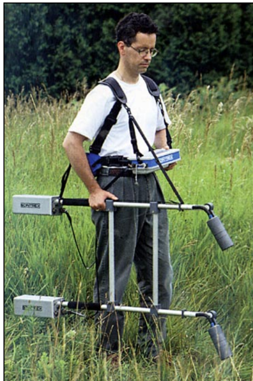
Obr. 14. Příklad způsobu magnetometrického průzkumu pomocí gradientové varianty měření aparaturou Smartmag SM-4g (foto – zdroj: www.scintrexltd.com ).
