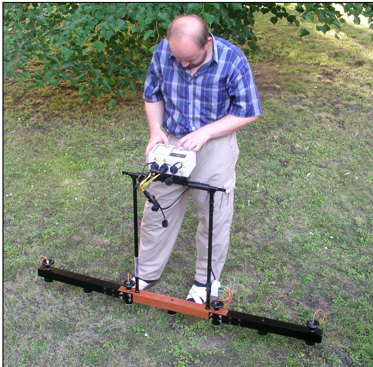
Obr. 15. Příklad způsobu geoelektrického odporového měření metodou SOP s Wennerovým uspořádáním elektrod A0,5M0,5N0,5N0,5B pomocí aparaturou RM-15, Geoscan Research (foto M. Kuna).
