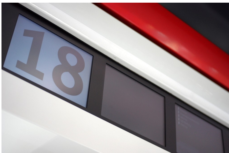
Obr. 65 – Pohled na zobrazovací zařízení v tramvaji Škoda 15T. Praha, duben 2011. Při pohledu sedícího cestujícího vzhůru na informační systém se projeví omezení daná technologií LCD obrazovkami. Kvůli malému pozorovacímu úhlu není zobrazená informace o trase čitelná.
