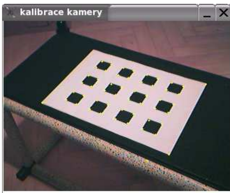
Obrázek 3.5: Výsledek hledání významných bodů pomocí Harris rohového detektoru.
