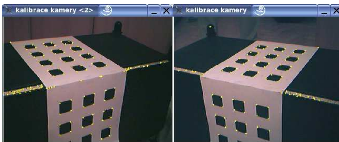
Obrázek 3.7: Kalibrační scéna s nalezenými kalibračními body.
