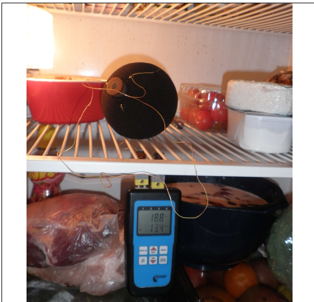
Kulový teploměr – vychlazování v ledničce před skokovou změnou
