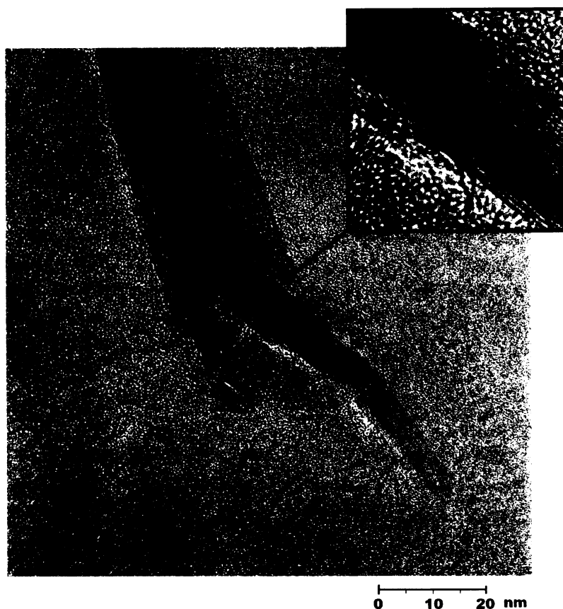
Obr. 35: Transmisní elektronová mikroskopie. Na snímku je atmosférická uhlíkatá částice s paralelně uspořádanými grafenovými vrstvami.
