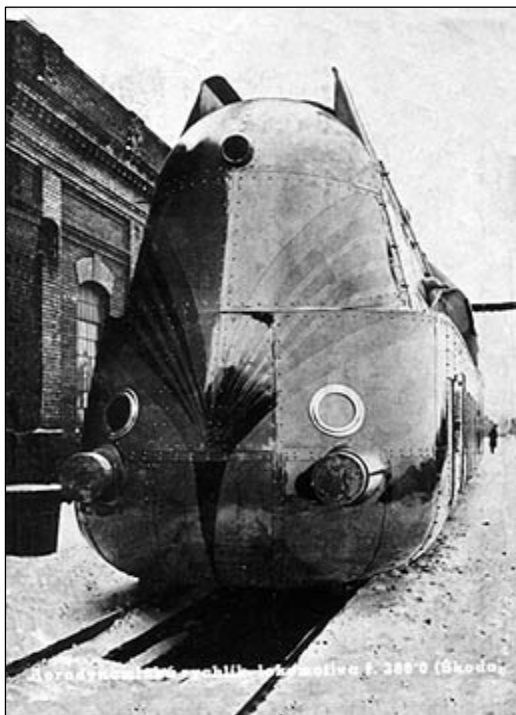
Obr. č. 20: Aerodynamické provedení lokomotivy řady 386.001, 1937.
