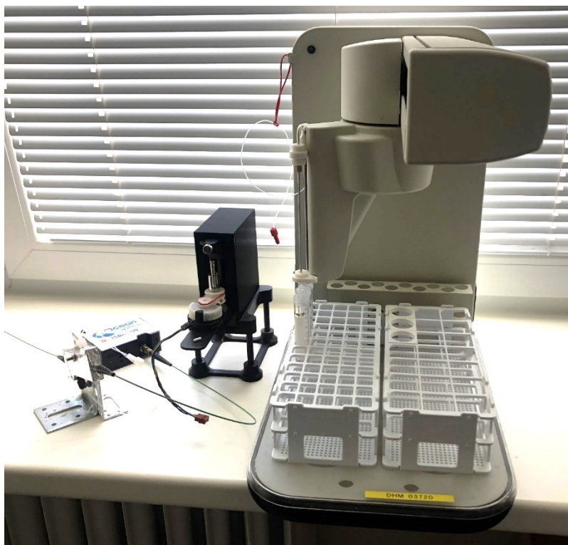
Obr. č. 4: Fotografie systému (autosampler, pístové čerpadlo a detekční cela s detektorem)
