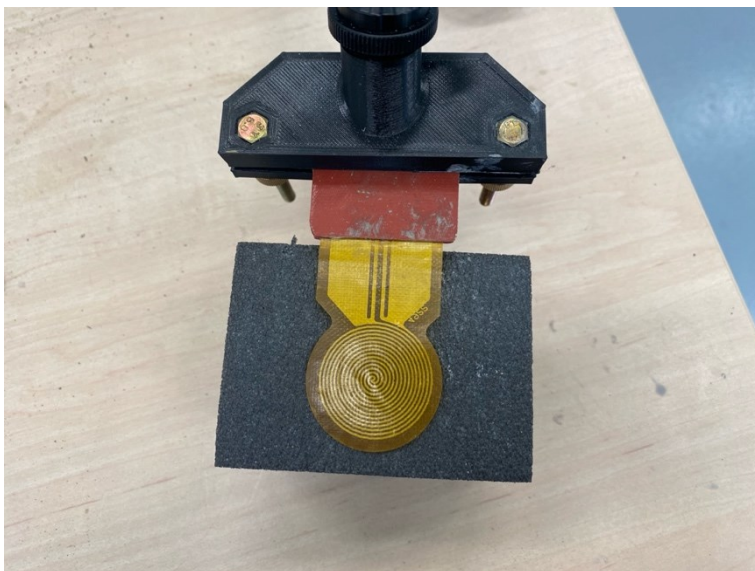
Obrázek 12: Hot Disk senzor, model 4922 o poloměru 14,6 mm
