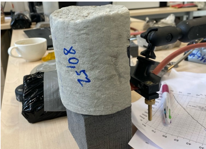
Obrázek 20: Vzorek měřený metodou Hot disk. Tepelné parametry měřené kolmo na vrstevnatost
