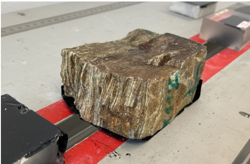
Obrázek 15: Vzorek ortoruly měřený metodou Optického skenování. V první pozici standard sklo, následně samotný vzorek, standard sklo a poslední titan.
