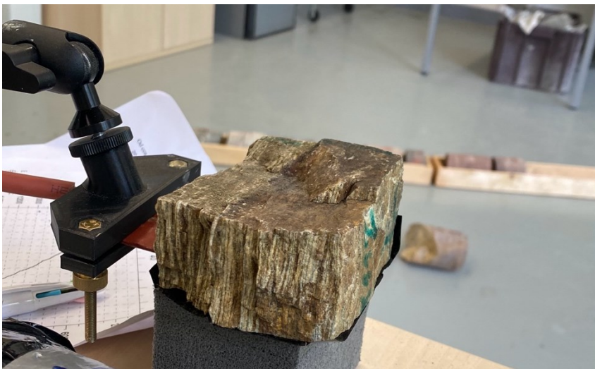
Obrázek 16: Vzorek ortoruly měřený metodou Hot disk. Zřejmé páskování světlých a tmavých poloh. Tepelné parametry měřeny podél vrstevnatosti.
