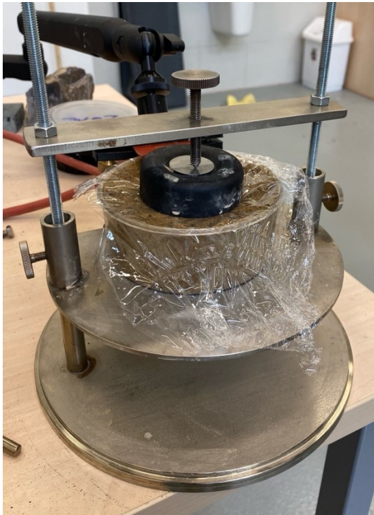
Obrázek 19: Vzorek vlhkého písku měřeného metodou Hot disk. Senzor je vložen mezi vzorek přikrytý folií a izolant
