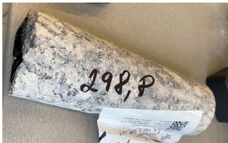
Obrázek 18: Vzorek hrubozrného granitu
