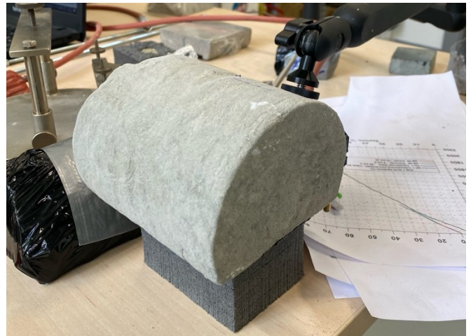
Obrázek 21: Tepelné parametry měřeny podél na vrstevnatost metodou Hot disk
