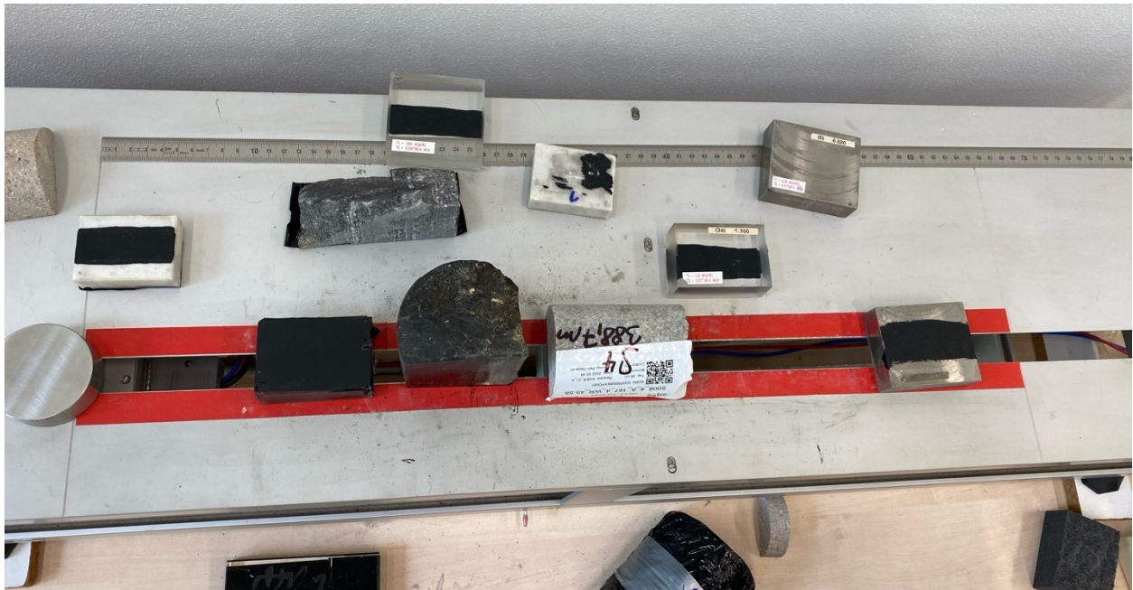
Obrázek 11: Měření metodou Optického skenování. Na první poloze linie skenu je uložený standard titan, následně vzorky hornin bazaltu a granitu a poslední druhý standard sklo
