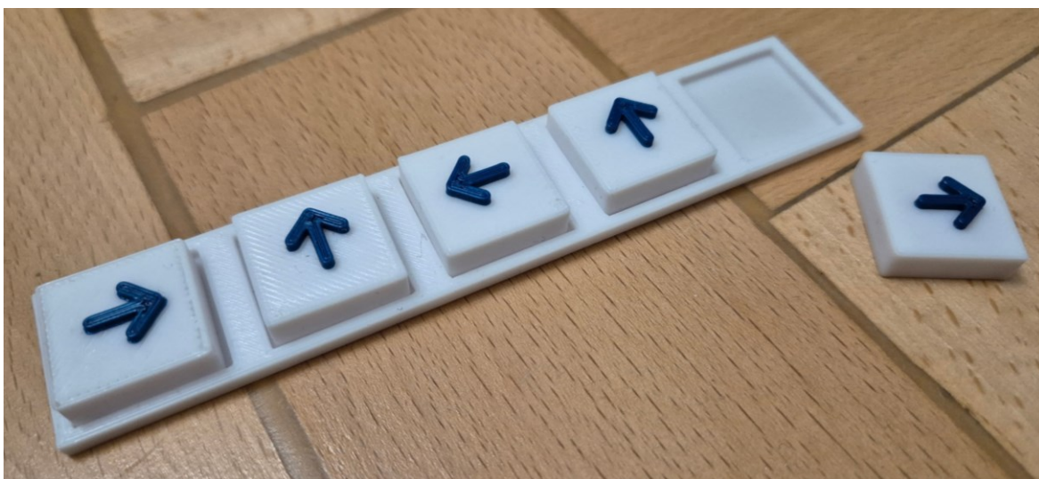
Obr. 89 – 3D šipky a box na šipky vytištěné na FDM tiskárně
