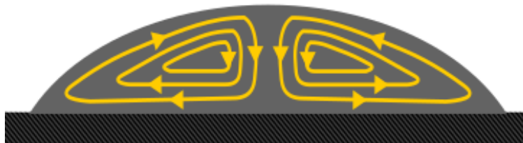
Obr. 1.7: Počas vysychania sa v kvapke vytvoria Marangoniho prúdy (naznačené žltými prúdnicami). Podľa práce Hua a kol. [15].
