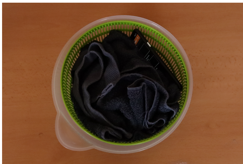
Obrázek 3.6: Mobil v odstředivce zadržený smotaným ručníkem
