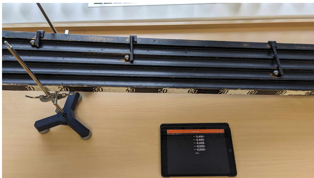
Obrázek 3.1: Padostroj s kuličkami v jednotlivých drahách. Zarážky jsou nastaveny na značky 10 cm, 40 cm, 90 cm. Na tabletu jsou časové intervaly naměřené pomocí funkce Akustické stopky .
