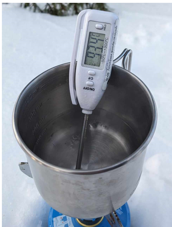
Obrázek 3.8: Měření teploty varu vody na vrcholu Liščí hory
