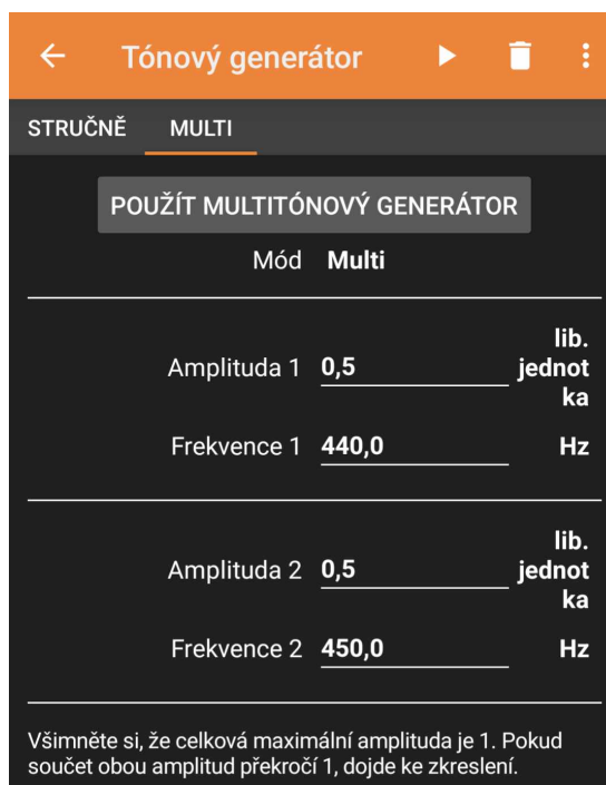
Obrázek 3.14: Zážněje pomocí generátoru tónů
