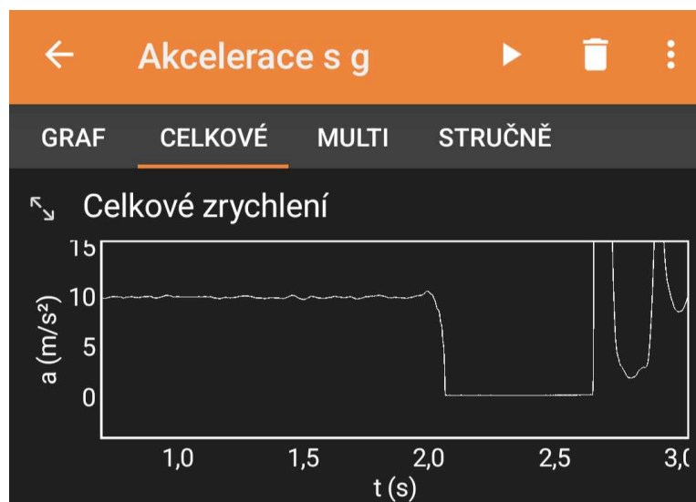
Obrázek 3.18: Měření zrychlení při volném pádu
