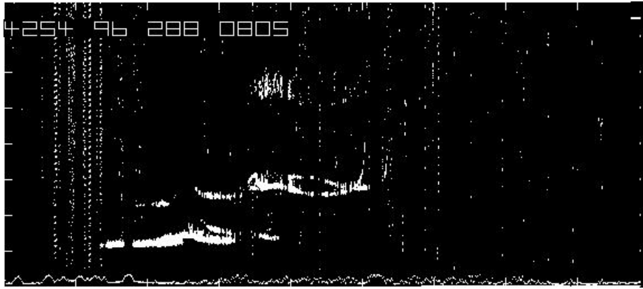
Obrázek 1.3: Ionogram ze stanice Průhonice změřený pomocí ionosondy IPS42 firmy KEL Aerospace. Na vodorovné ose je frekvence, na svislé ose je virtuální výška vrstev. Zaznamenány jsou odrazy z vrstev E, Es, F1 a F2. Na ionogramu je zobrazen řádný i mimořádný mód signálu.
