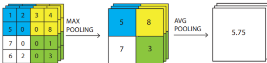
Obr. 7.4: Operácia MaxPooling a AvgPooling pre data[50].
