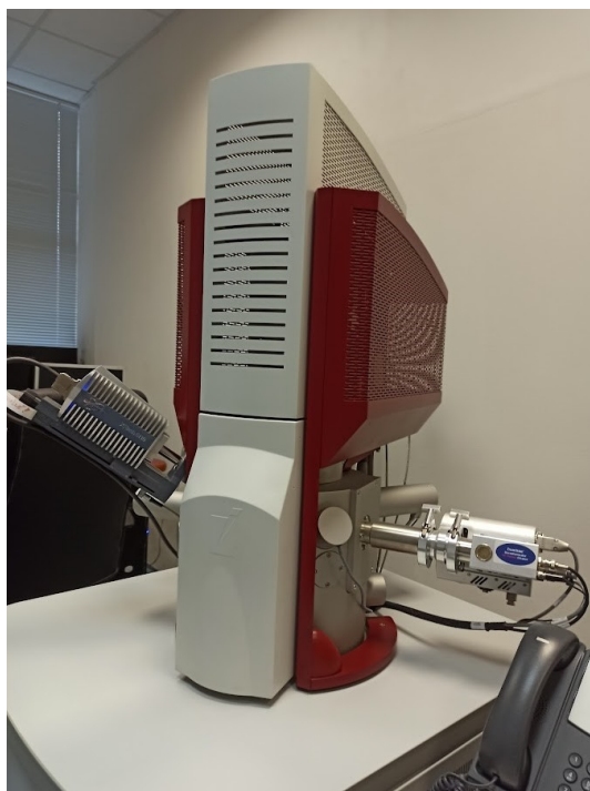
Obrázek 10: Řádkovací elektronový mikroskop Tescan MIRA 3 použitý v experimentu.
