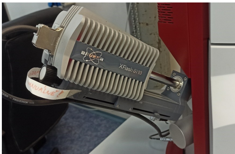
Obrázek 11: Použitý detektor EDX Bruker XFlash připojený k řádkovacímu elektronovému mikroskopu Tescan MIRA 3.
