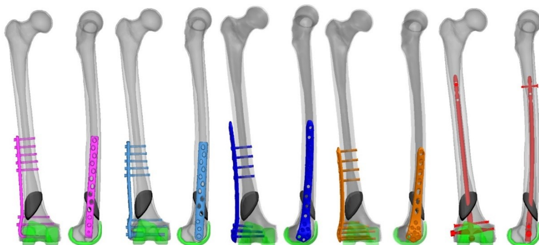
Obrázek 15 – Předozadní a boční pohled na model femuru s jednotlivými implantáty Femorální komponenta (zelená), zlomenina (černá) a implantáty: kondylární dlaha (fialová), DCS dlaha (světle modrá), NCB (tmavě modrá), LISS (oranžová) a DFN (červená).
