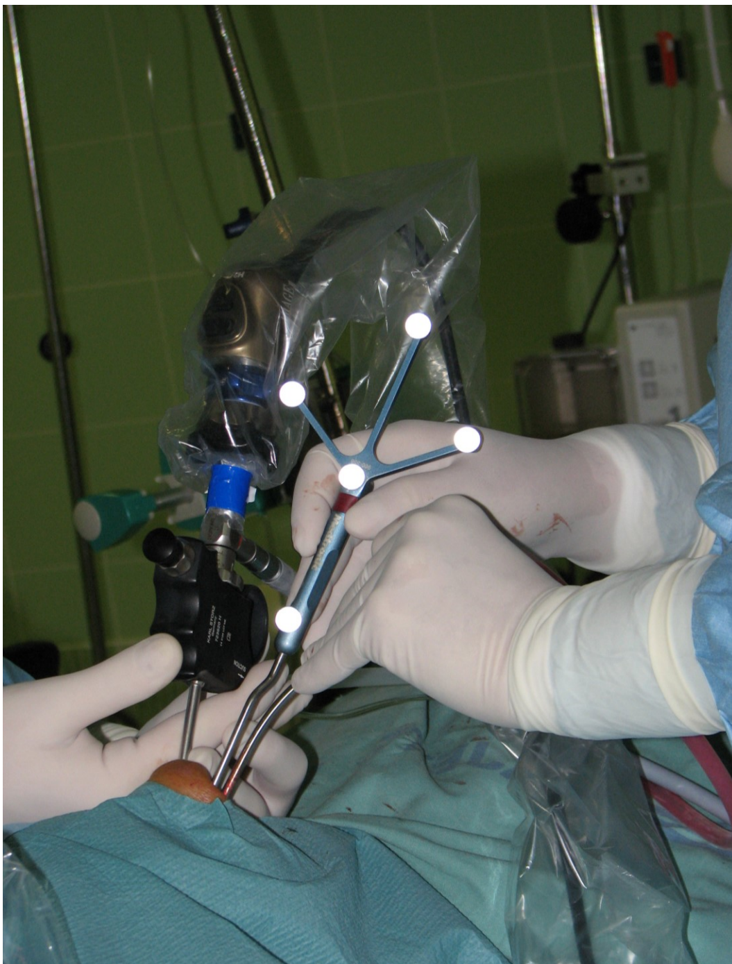
Obr. 9 - ukazovátko optické navigace při výkonu, jsou dobře patrné registrační kuličky, které musí kamera navigace stále „vidět“ (Zdroj: autor)
