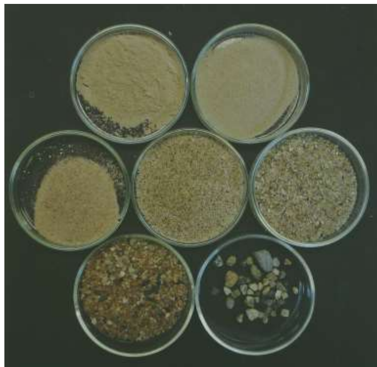
11. Vstupní průzkum omítek při opravě kostela sv. Jana Nepomuckého na Skalce (Ing. Petr Kuneš, 2012): dokumentace kameniny zdiva – zkoumání původní hrubosti omítky
