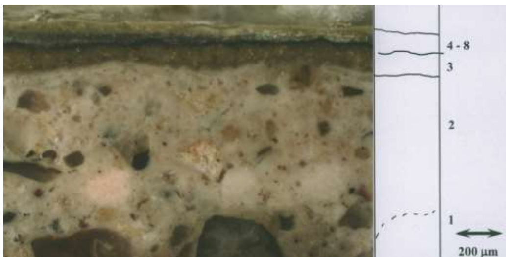
12. Vstupní průzkum omítek při opravě kostela sv. Jana Nepomuckého na Skalce (Ing. Petr Kuneš, 2012): stratigrafie povrchových úprav
