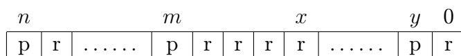
Obrázek 3.2: Struktura datového souboru, p značí plnou verzi, r verzi uloženou jako rozdíl
