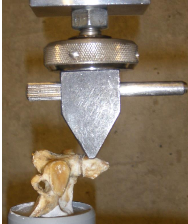
Obr. 27 Zatěžování oblasti dentu fixovaného v PMMA bločku v předozadním směru pomocí mechanického tlakového přístroje
