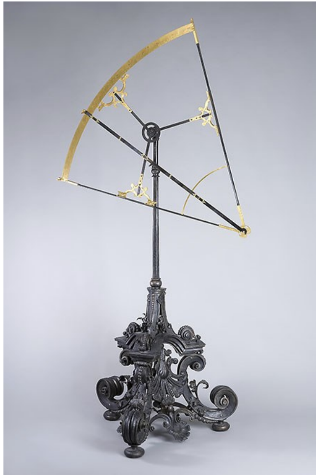
60. Erasmus Habermel , sextant, 1600, zlacená mosaz a železo, 1356 x 2730 x 1000 mm. Národní technické muzeum Praha, 24 551
