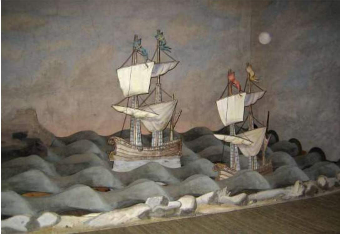
10. Spirálovitě stočená hřídel k docílení vodní hladiny používané v Drotningholmském divadle
